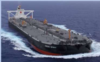
VLCC (超大型タンカー) 長さ: 約300m 速度: 約13ノット Fr = 0.123
