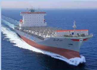
コンテナ船 (3,000TEU) 長さ: 約200m 速度: 約22ノット Fr = 0.256
